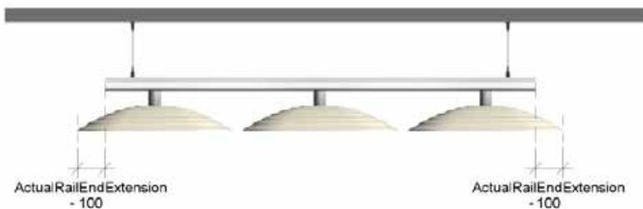
Bei der Dokumentation eines abgehängten Systems kann die Position des ersten und letzten Abhängeseils über den Parameter **DesiredEndCableInset** gesteuert werden, der automatisch validiert wird, um im zulässigen Bereich zu bleiben.
