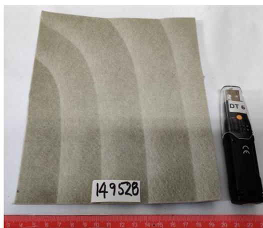
Fuji Paneel-Probe, 97,7 % PET, (64 % recycelt)/ 2,3 % PCL
